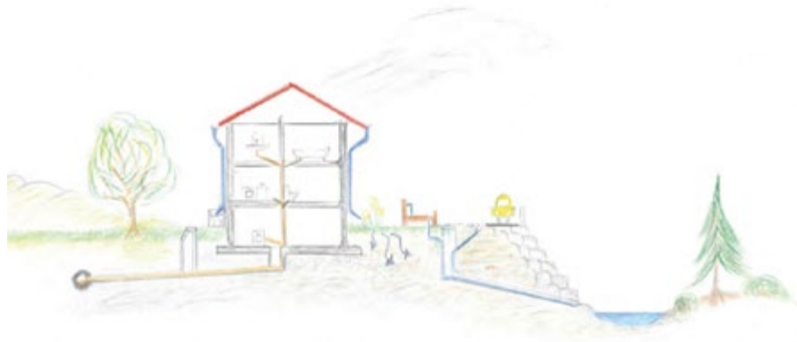
Trennsystem: getrennte Schmutz(ARA)-Leitung und Regenwasserleitung (Bach).
