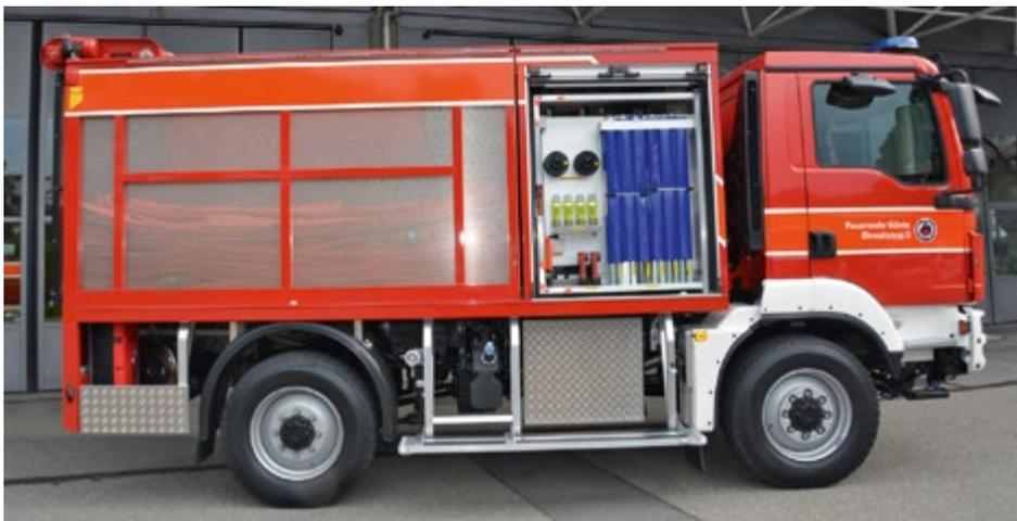
Alles in einem Fahrzeug: Zusatzmaterial für die Schläuche sowie für die Strassensignalisation kann problemlos und platzsparend mitgeführt werden.
